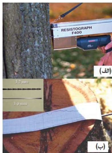
شکل ۱- پایش وضعیت تنه درخت بوسیله روش مقاومت نگاری (الف) دستگاه مقاومت نگار (رزیستوگراف) (ب) نوار گراف تغییرات سختی چوب در مسیر ورود مته به درون تنه
