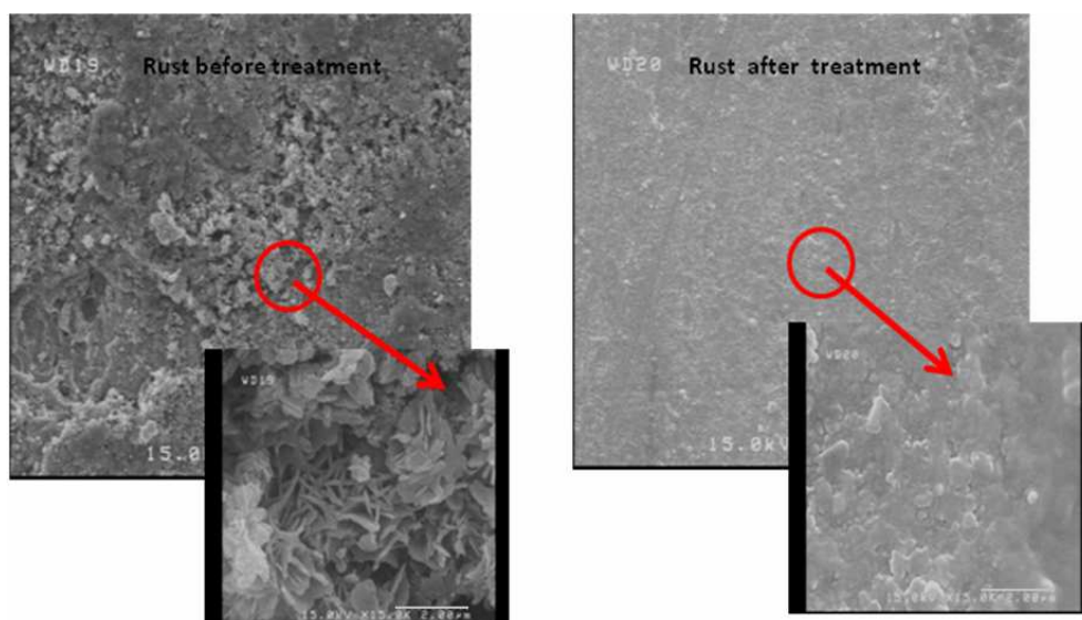
شکل ۷: سطح فلز زنگ‌زده بدون آماده‌سازی در مقایسه با سطح فلز زنگ‌زده آماده‌سازی شده در محلول آبی حاوی ۲۰٪ اسید فسفریک در pH=2 و زمان غوطه‌وری ۵ ساعت. میزان بزرگنمایی تصویر به ترتیب ۲۰۰۰ برابر و ۵۰۰۰ برابر می‌باشد.
