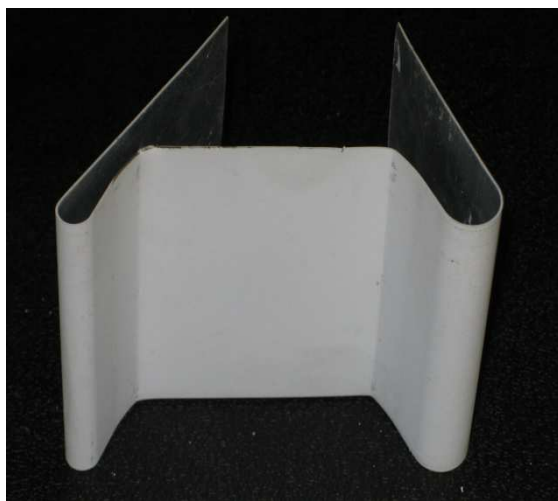
شکل ۹: تصویر از سطح نمونه D (رنگ با نسبت رنگ‌دانه به رزین ۱:۳) پس از انجام آزمون خمش.
