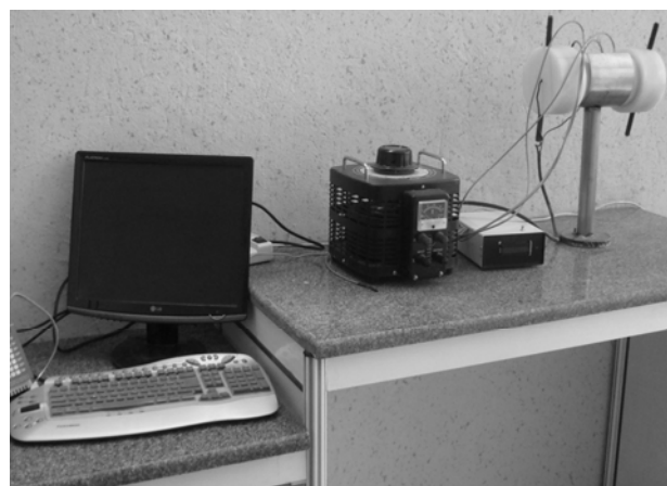
شکل ۱ تصویر شماتیک از محفظه تیمار و نیز تصویر سیستم اهمیک ناپیوسته مورد استفاده
