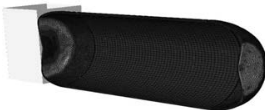
شکل ۲- مدل تغییر شکل یافته مخزن پس از تصادم عمودی
