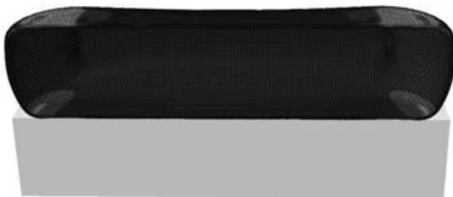
شکل ۱- مدل تغییر شکل یافته مخزن پس از تصادم افقی
