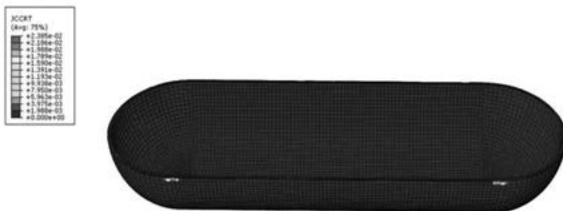
شکل ۱۳- مدل تغییر شکل یافته مخزن پس از سقوط افقی
