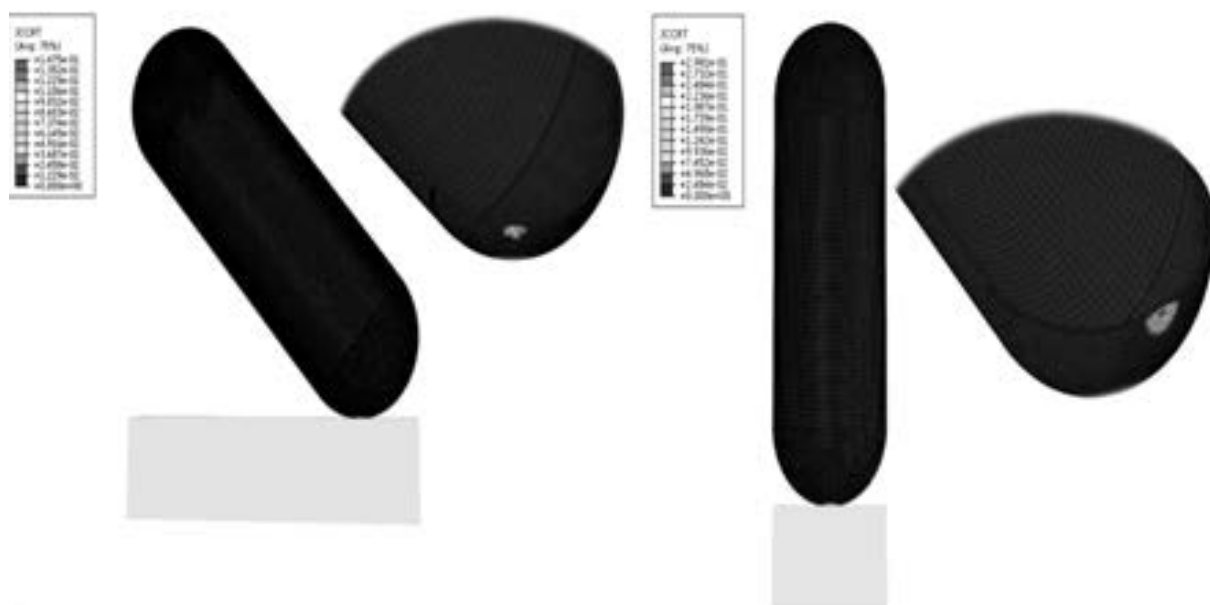
شکل ۱۲- مدل تغییر شکل یافته مخزن پس از سقوط قائم و مایل
