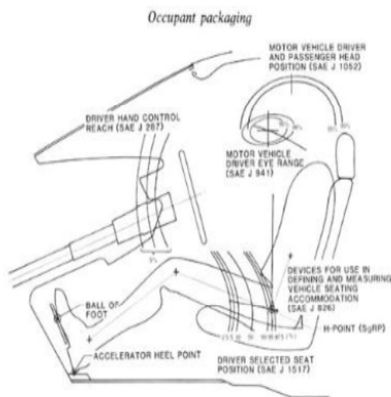
شکل ۱: ابعاد و اندازه های ارگونومیک در طراحی فضای داخل خودرو (بسته سرنشین)
