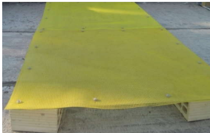
شکل شماره (۲): تله مورد استفاده جهت جمع آوری گرد و غبار
