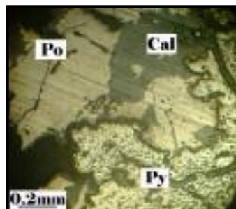
شکل ۱۳ تصویر مقطع نازک صیقلی اسکارن دارای پیروتیت و پیریت، Po: پیروتیت، Py: پیریت، Cal: کلسیت.
