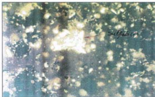
شکل 1- قطعات سولفات نیکل موجود در نمونه (x 200)
