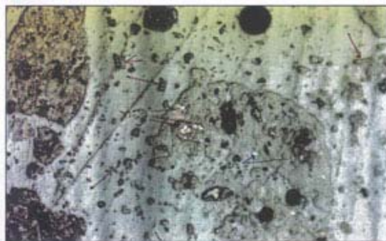
شکل 2- قطعات مس طبیعی و روی فلز در نمونه (x 200)
