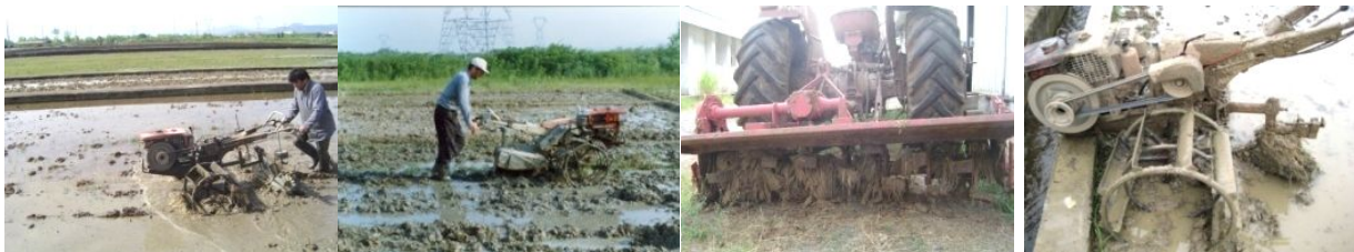
الف) خاک‌همزن مرسوم تیلری (ب) رتیواتور تراکتوری (ج) خاک‌همزن دوار تیلری (د) پادله مخروطی تیلری شکل ۱. ادوات مرسوم برای عملیات پادلینگ در شالیزار (الف و ب) و ادوات ساخته شده توسط مؤسسه تحقیقات برنج برای عملیات پادلینگ در شالیزار (ج و د)
