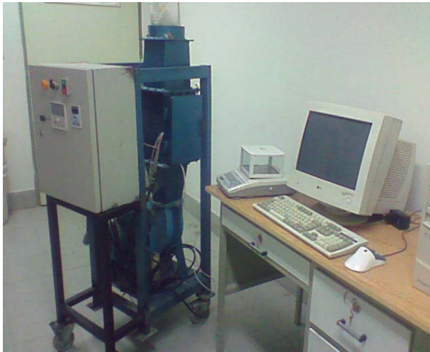
شکل ۱- دستگاه خشک‌کن جریان هوای داغ به همراه ترازو
