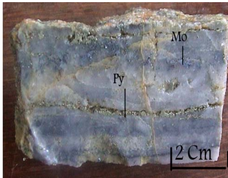
شکل ۲. تصویری از رگه پیریت که در مرکز رگه کوارتز- مولیبدنیت قرار گرفته است پیریت: Py مولیبدنیت: Mo.
