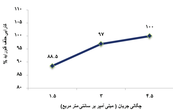
نمودار ۳. اثر چگالی جریان روی حذف فلوراید در رآکتور ناپیوسته الکتروکواگولاسیون
