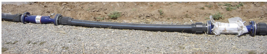
شکل 1- روش قراردادن دستگاه مغناطیسی مورد استفاده در مسیر آب
