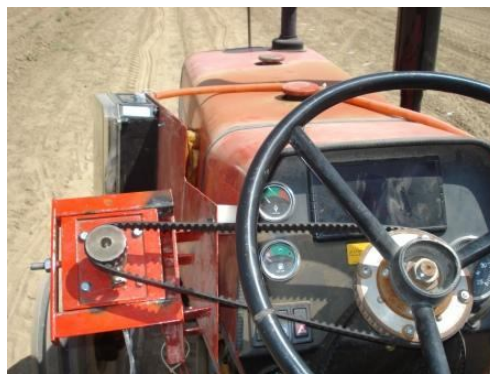
شکل ۲- مکانیزم محرک فرمان توسط پولی و تسمه دندانه دار
