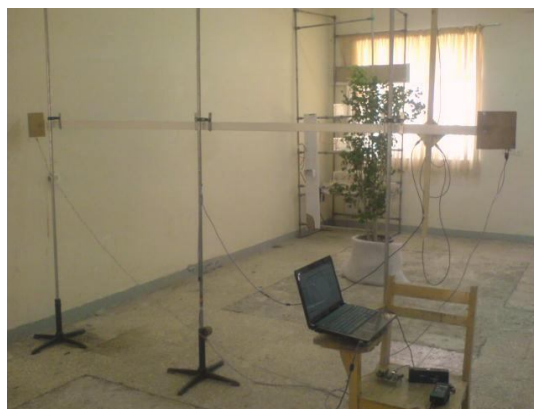
شکل ۵- اندازه‌گیری فراصوتی حجم درخت
