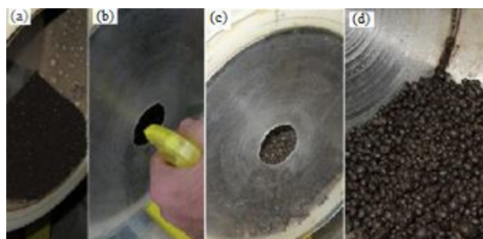
شکل ۳- مراحل تولید گرانول با استفاده از استوانه دوار؛ (a) قرار دادن مقدار کود مشخص در استوانه، (b) اسپری چسباننده به داخل استوانه، (c) رشد و بزرگ شدن ذرات کود در زمان مشخص، (d) گرانول تولید شده
