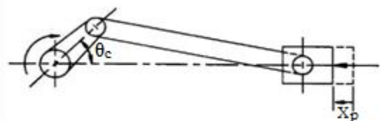
شکل ۴- طرحواره اتصال لنگ و پلانجر دستگاه بسته‌بند Fig.4. Schematic of the crank and plunger in baler
