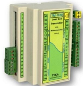
شکل ۲- ترنس‌میتور استفاده شده برای واسنجی بارسنج Fig.2. Transmitter used for load cell calibration
