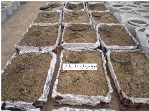
شکل ۲. جعبه‌های حاوی خاکدانه و حفاظ پیرامون آن برای اندازه‌گیری پاشمان (الف) نمونه‌های برداشته‌شده به وسیله سیلندر برای اندازه‌گیری تخریب و تراکم خاک (ب)
