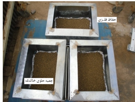
شکل ۲. جعبه‌های حاوی خاکدانه و حفاظ پیرامون آن برای اندازه‌گیری پاشمان (الف) نمونه‌های برداشته‌شده به وسیله سیلندر برای اندازه‌گیری تخریب و تراکم خاک (ب)
