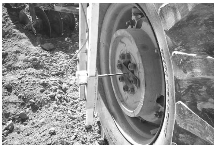
شکل ۲ - دستگاه دریابه نوع انکودر کوبله شده به محور چرخ تراکتور
