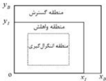
شکل ۱. هندسه حوزه محاسباتی میدان زمینه، خطوط پُر بیرونی منطقه گسترش و خطوط پُر داخلی منطقه واهلش و خطوط نقطه چین داخلی منطقه انتگرال گیری را نشان می دهد (هاگن و مکنهاور، ۱۹۹۳).
