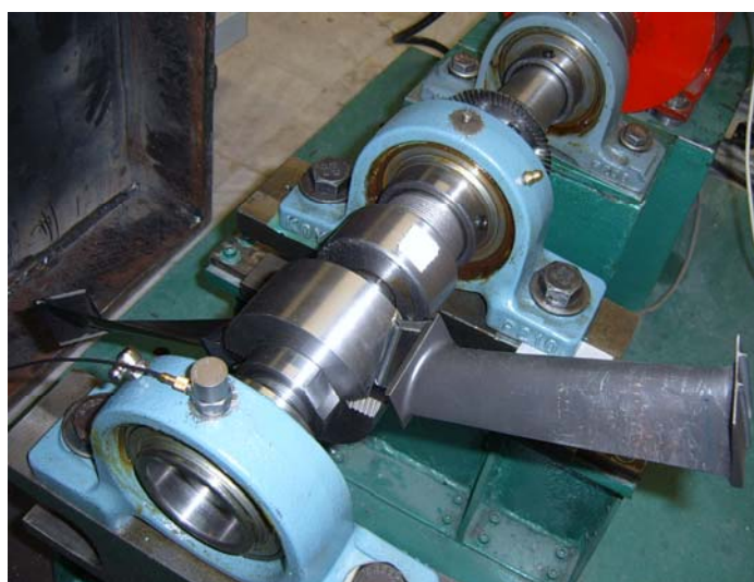
شکل ۲- نحوه تست آزمایشی پره در آزمایشگاه
