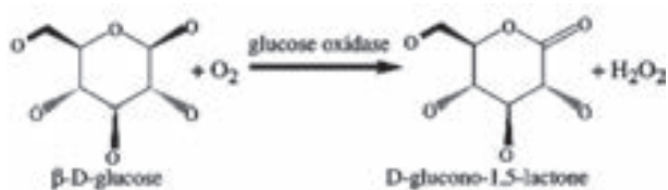
شکل ۴- شماتیک واکنش شناسایی گلوکز توسط آنزیم گلوکز اکسیداز
