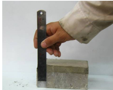
شکل ۱ لایه خود متراکم تعمیری اعمال شده به ضخامت ۲ سانتی متر روی بتن بستر با ضخامت ۵ سانتی متر.
