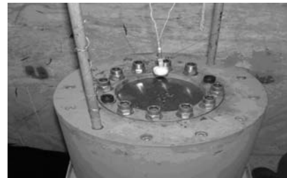
شکل (۲): نحوه قرارگیری ماده منفجره و تثبیت آن.
