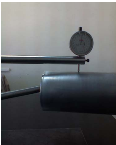
شکل (۱۰): نحوه اندازه‌گیری ضخامت در نقاط مختلف قطعه با استفاده از دستگاه نشان داده شده در شکل ۹.
