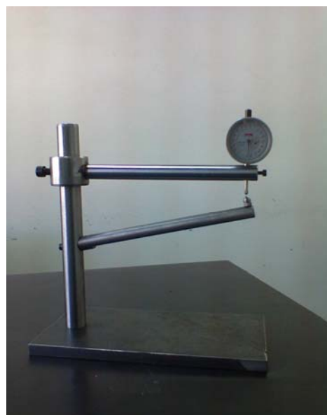
شکل (۹): دستگاه استفاده شده برای اندازه‌گیری ضخامت قطعات.
