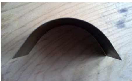
شکل (۸): یک نمونه ورق فولادی به ضخامت ۱ میلی‌متر پس از فرآیند خمش پلاستیک خمش بر روی بستر لاستیکی.
