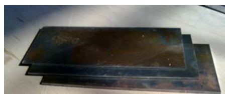
شکل (۷): نمونه‌های ورق‌های فولادی قبل از فرآیند خمش بر روی بستر لاستیکی.
