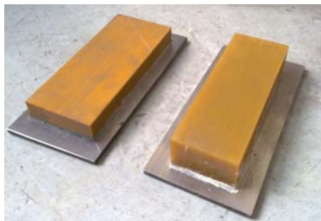
شکل (۶): بستر لاستیکی با ضخامت ۵۰ میلی‌متر (سمت راست) و با ضخامت ۳۵ میلی‌متر (سمت چپ).
