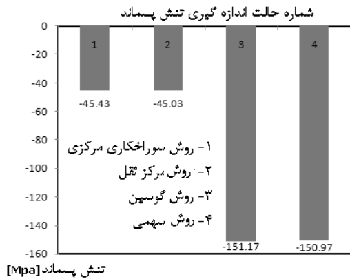
شکل (۱۶): تأثیر پارامتر پرتو K\alpha_2 بر روی تنش پسماند.
