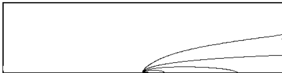
شکل (۷): کانتور ورتیسیتی لایه مرزی (لایه مرزی بر روی نصف طول صفحه زیرین میدان محاسباتی تشکیل می‌شود).
