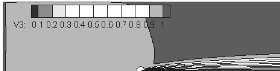
شکل (۸): لایه مرزی تشکیل شده بر روی نصف صفحه زیرین میدان محاسباتی.
