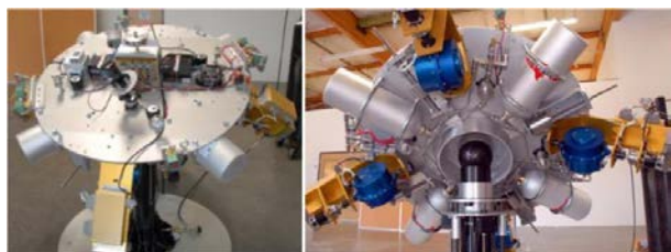
شکل (۱): نمونه‌ای از شبیه‌ساز یاتاقان هوایی نیمه کرووی.
