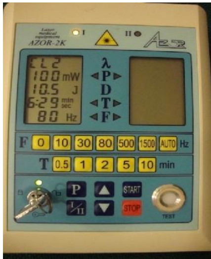
تصویر ۲: تصویر دستگاه لیزر کم توان و پارامترهای تنظیم شده در مطالعه
