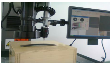
شکل ۸. اندازه گیری شعاع انحناء با ماشین CMM
