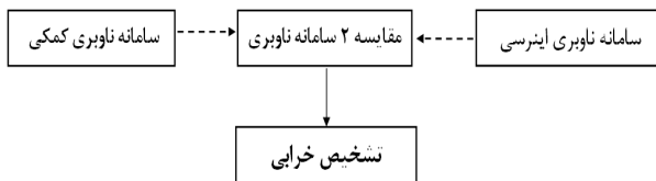
شکل ۱ الگوریتم شناسایی و تشخیص خرابی با استفاده از سنسور نرم
