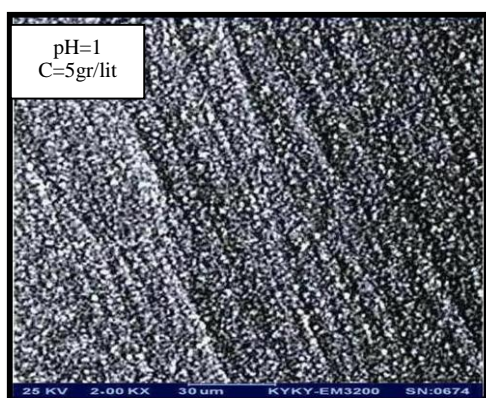
شکل (۹): تصویر تهیه شده توسط SEM از رسوب آهن تولید شده در غلظت ۵ گرم بر لیتر در pH ۱
