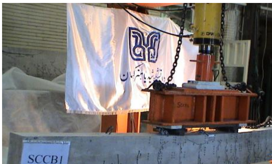
شکل ۳ - ب: نحوه بارگذاری، پیشروی ترک‌ها و... مربوط به نمونه ای از تیرهای آزمایش شده.
