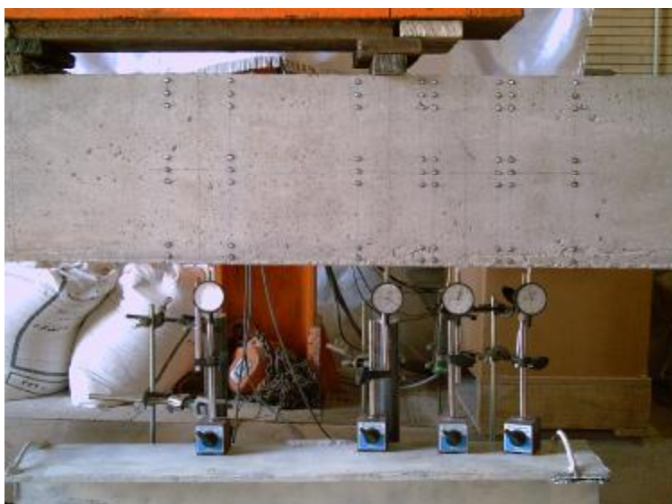
شکل ۳ - الف: چگونگی نصب دستگاه‌ها و تجهیزات جهت قرائت کرنش و خیز مربوط به نمونه ای از تیرهای آزمایش شده.
