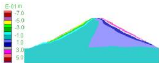
شکل ۱۴-الف: کنتورهای تغییر مکان افقی پس از زلزله - سد با هسته مایل.
