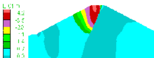
شکل ۱۳-الف: کنتورهای نشست پس از زلزله - سد با هسته مایل.
