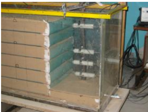
شکل ۲: نمونه‌ای از مدل دیوار خاکی مسلح شده به همراه حسگرها.
