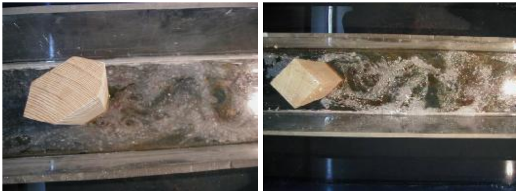
الف) الگوی جریان در مدل آزمایشگاهی.
