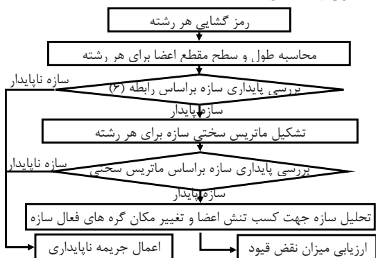
شکل ۵ بخشی از مراحل بهینه بایی مقاطع و توپولوژی خرپاها بر اساس GA
