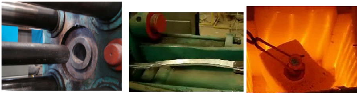
اکستروژن گرم → فوم کردن تکه‌ای از تسمه در قالب داخل کوره
