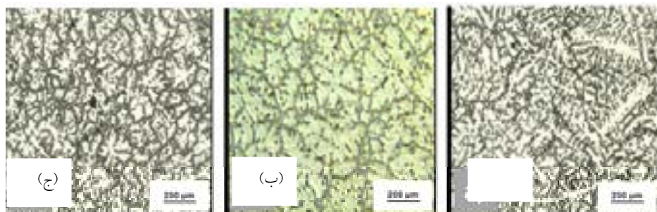
شکل ۵- ریزساختار دندریتی نمونه های (الف) بدون تقویت کننده، (ب) ریخته شده به روش عملیات فوق گداز مذاب و نیز (ج) کامپوزیت حاوی ۲/۵ درصد وزنی نانو زیرکونیا + ۲/۵ درصد میکرو زیرکونیا.
