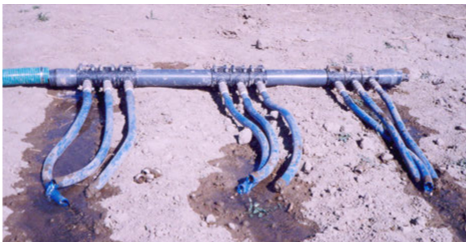
شکل ۴: سیستم توزیع آب در جویچه‌های تحت مطالعه
