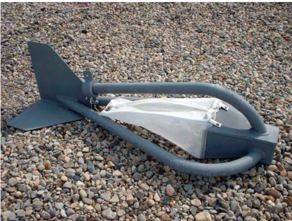
شکل ۱: نمونه بردار بار بستر هلی اسمیت مورد استفاده
