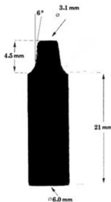
تصویر ۱: طرح و اندازه نمونه دای برنجی مورد استفاده در این مطالعه
