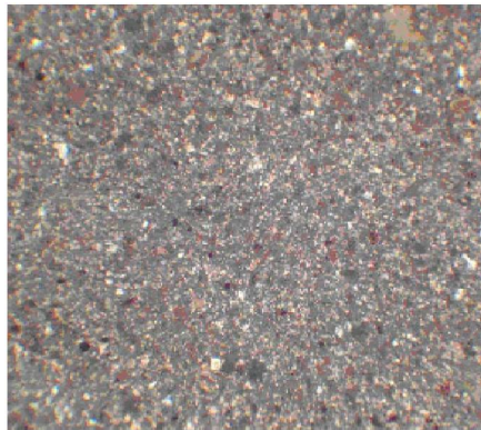
شکل ۵- تصویری از مقطع نازک تهیه شده از نمونه معرف با بزرگنمایی ۱۰۰ برابر که ذرات باریت با رنگ سفید در آن مشخص است.
