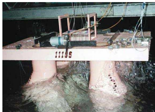
شکل-۷: تست مدل اجسام لیفت‌ساز در شناور Aliswath در آزمایشگاه کریلف روسیه
