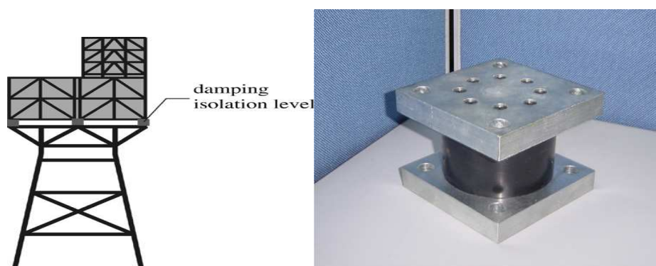
الف) نمای یک جداساز در حال مطالعه برای سکوهایی دریایی ب) کاربرد جداساز در سکوی ثابت نوع
