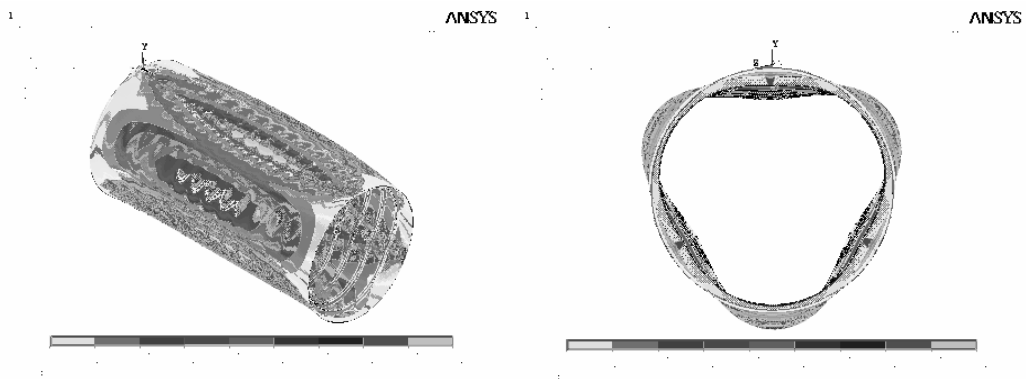
شکل (۴): شکل کمانش یافته پوسته در نرم افزار ANSYS
