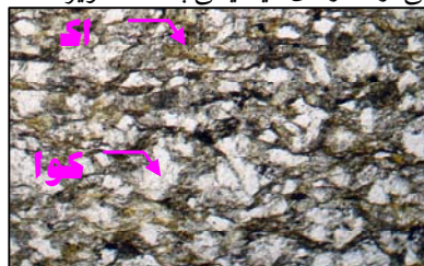
تصویر ۱۲- نمایی از فنو کریستهای کوارتز همراه با اکسیدهای آهن که در جهت لایه بندی پراکنده شده اند (حالت PPL بزرگنمایی ۴۰)
