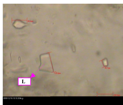
شکل ۸- سیال درگیر تک فازه مایع
