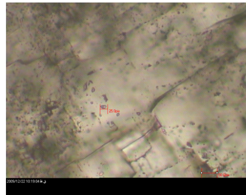
شکل ۴- تصاویری از سیالات درگیر مطالعه شده در کانی های باریت و رگچه های کوارتز
